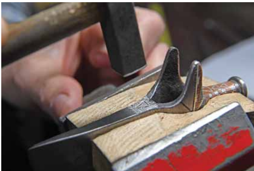
Obr. D-6: Aplikace stříbrného drátku na zdrsňený povrch; foto: Eva Řezáčová © Technické muzeum v Brně
