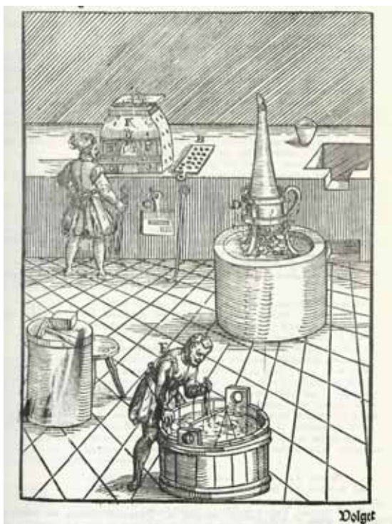
Obr. 5: Prubířská dílna. A – prubířská pec, v níž prubíř zkouší, B – železný plech, na nějž se vylévají průby, C – dřevěné zařízení, jehož štěrbinou se díváme do pece, aby oheň neškodil zraku, D – odlučovací baňka pro zlatou průbu, stojící na nožkách, E – dělník, který váží zlatnaté stříbro ve vodě (Erckera, 1982, s. 117)
