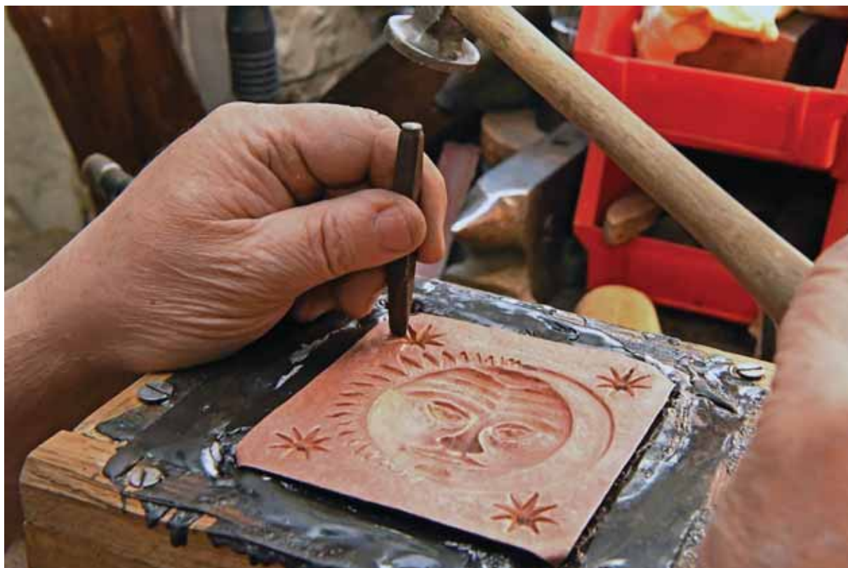
Obr. B-7: Postupné tepání jednotlivých reliéfů na reverzní straně; foto: Eva Řezáčová © Technické muzeum v Brně
