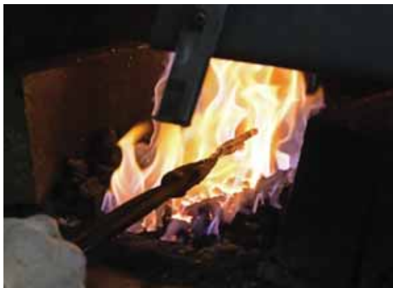
Obr. E-7: Pokrytí spodní strany předmětu ochranou jílovou vrstvou pro zamezení opalu při inkrustačním ohřevu; foto: Eva Řezáčová © Technické muzeum v Brně
