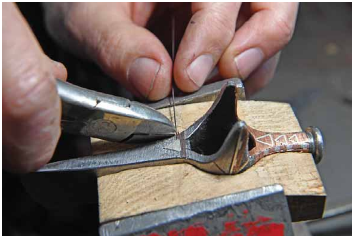
Obr. D-8: Vyplnění povrchu dalšími stříbrnými a měděnými drátky; foto: Eva Řezáčová © Technické muzeum v Brně
