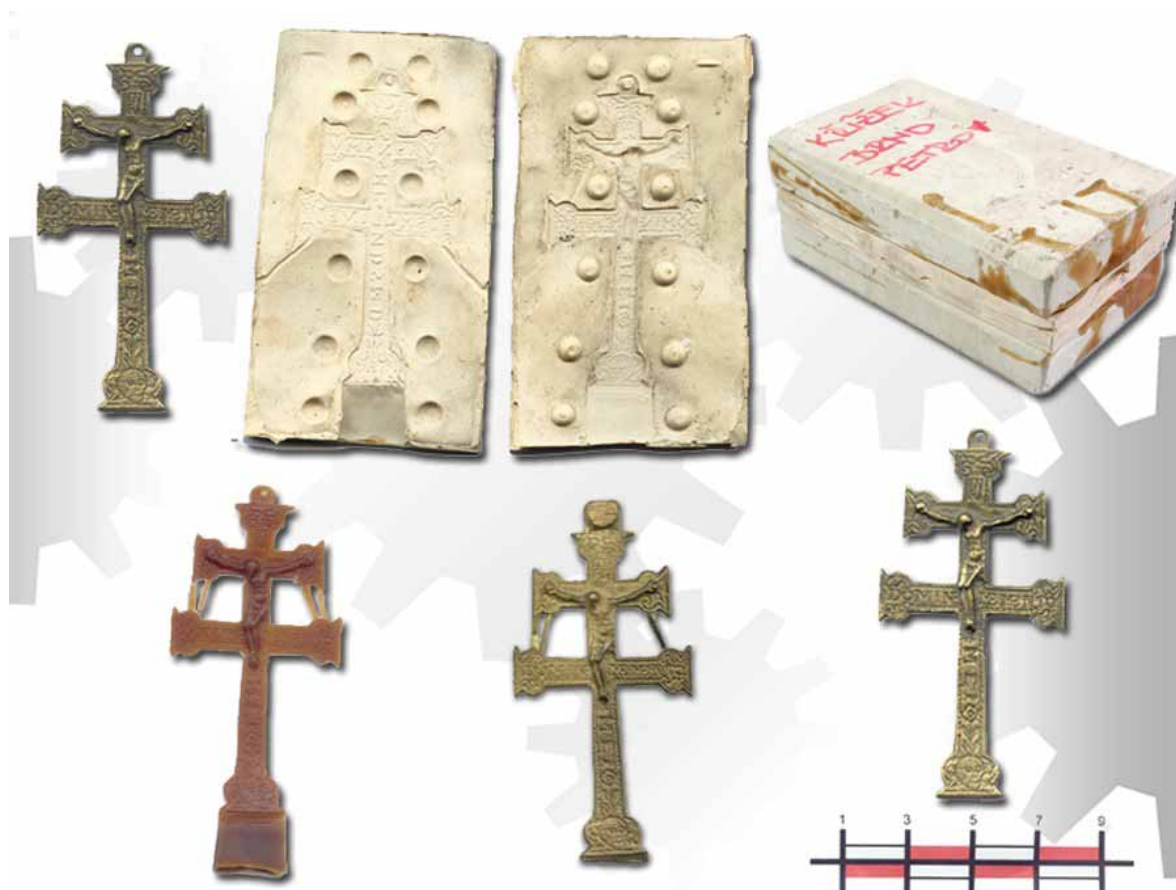
Obr. 3: Ukázka postupu zhotovení voskového modelu křížku a jeho odlití; foto MCK© Technické muzeum v Brně
