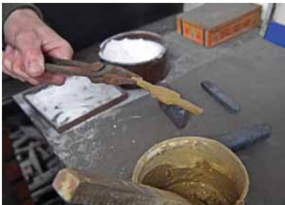
Obr. E-7: Pokrytí spodní strany předmětu ochranou jílovou vrstvou pro zamezení opalu při inkrustačním ohřevu; foto: Eva Řezáčová © Technické muzeum v Brně
