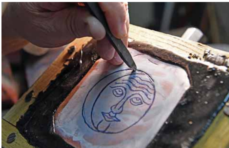
Obr. B-3: Vybraný čakan údery kladívka kopíruje předkreslený motiv pro nejhlubší reliéf; foto: Eva Řezáčová © Technické muzeum v Brně
