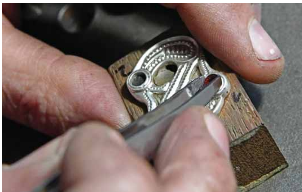
Obr. F-6: Instalace granátové vložky do otvoru; foto: Eva Řezáčová © Technické muzeum v Brně
