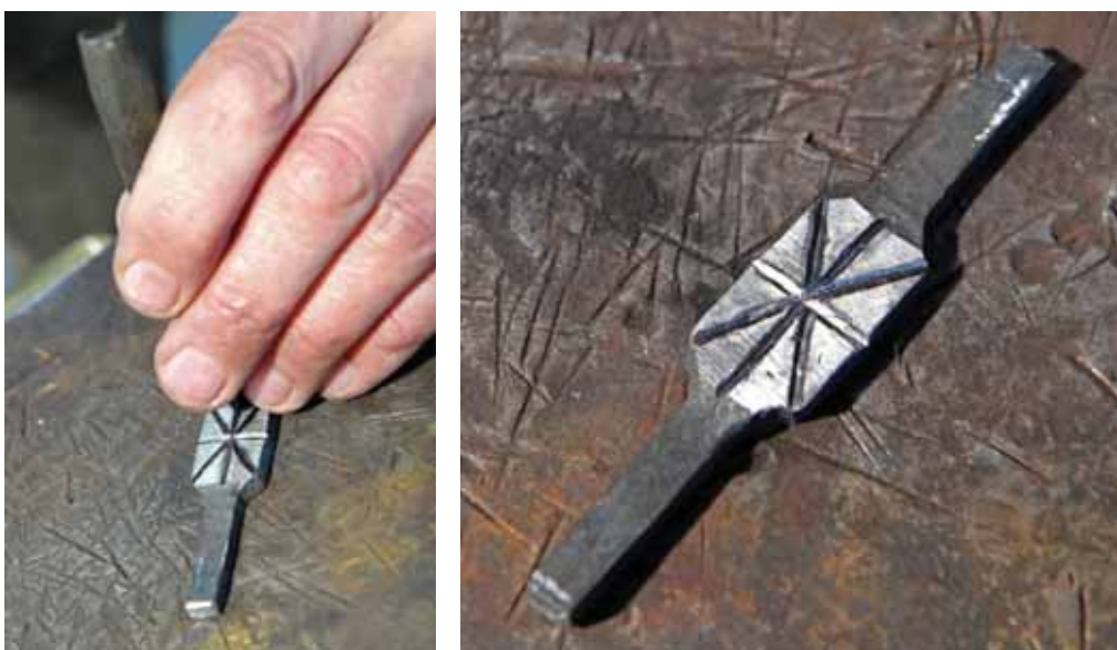
Obr E-6: Rýhy předkresleného dekoru byly vycizelovány čakanem; foto: Eva Řezáčová © Technické muzeum v Brně
