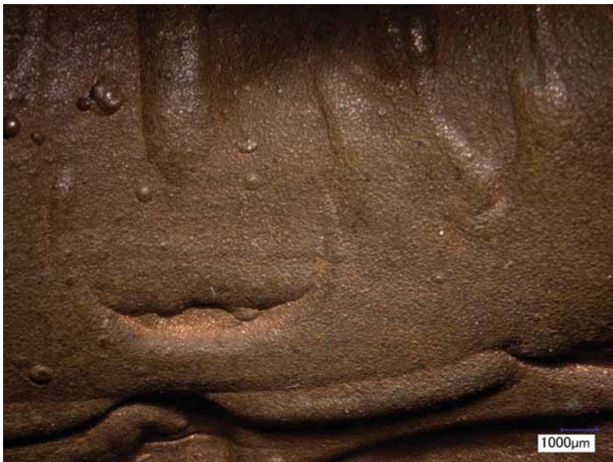
Obr. 6: Podnos se dvěma konvicemi, polotovar galvanické kopie, ze sbírky Uměleckoprůmyslového musea v Praze, mikrofotografie detailu zrnitého povrchu vnitřní strany; foto: MCK © Technické muzeum v Brně.
