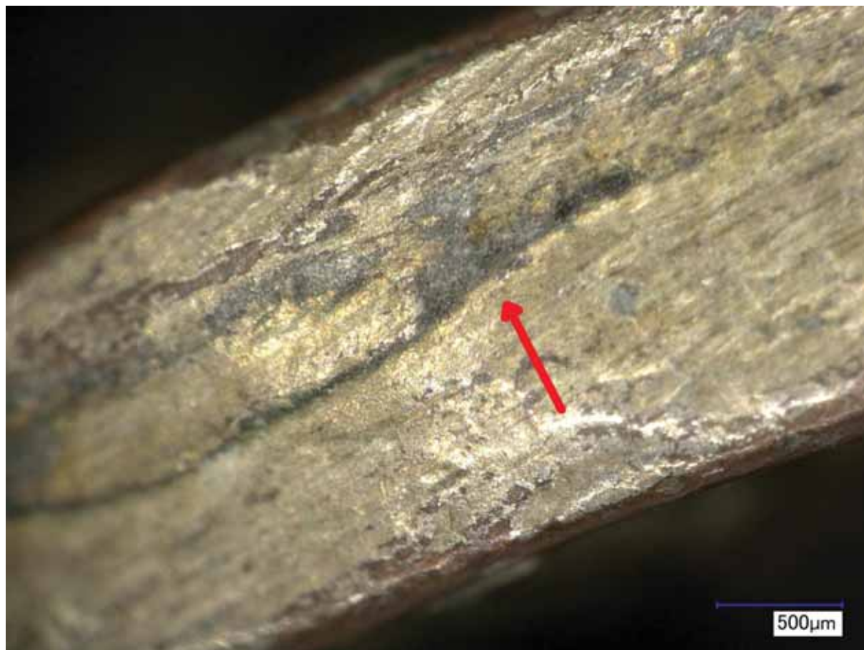
Obr. 5: Galvanoplastická kopie mince – drachmy , mikrofotografie boční hrany s charakteristickým švem spojení averzu a reverzu mince; foto: MCK © Technické muzeum v Brně
