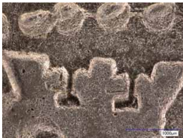
Obr. H-12 až H-17: Srovnání povrchu ražené (vlevo) a lité mince (vpravo); foto: MCK © Technické muzeum v Brně
