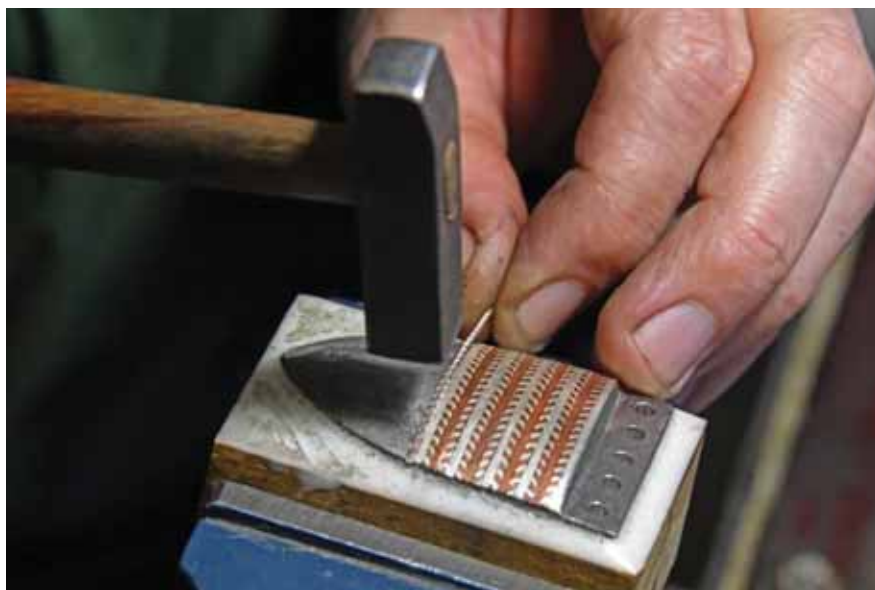
Obr. C-6: Upevnění vložek – aplikace drátkové vložky do připravené drážky pomocí kladívka; foto: Eva Řezáčová ©Technické muzeum v Brně
