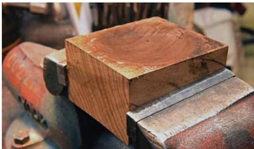
Obr. B-4: Pro nejhlubší vytažení plechu byl vyroben dřevěný špalík s dutinou; foto: Eva Řezáčová © Technické muzeum v Brně
