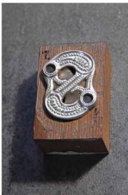
Obr. F-3: Ražení – štancování dekorativního vzoru fólie ocelovou raznicí na olověné desce; foto: Eva Řezáčová © Technické muzeum v Brně
