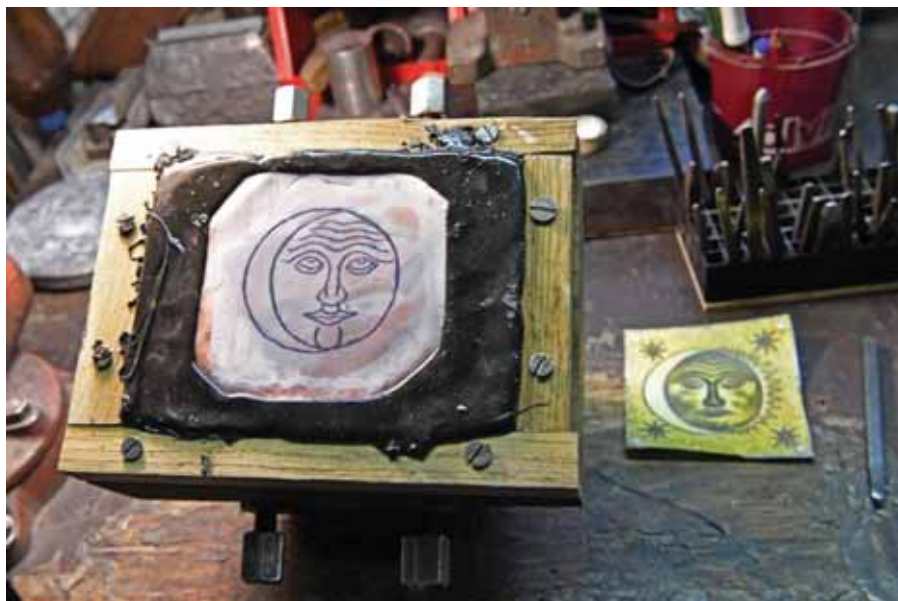
Obr. B-2: Dřevěná kazeta s uchyceným měděným plechem v tmelu a překreslený motiv, originální obrázek motivu po pravé straně; foto: Eva Řezáčová © Technické muzeum v Brně
