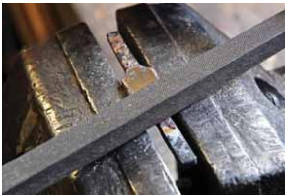
Obr. E-11: Mechanické odstranění zbytků tavidla a ochranného krytu; foto: Eva Řezáčová © Technické muzeum v Brně
