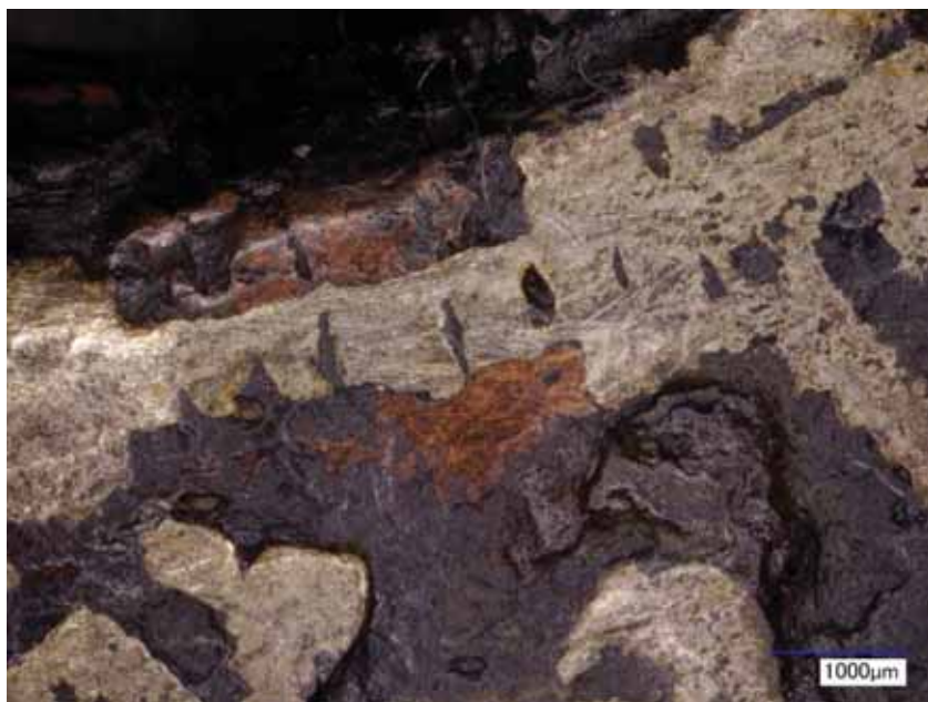
Obr. D-2: Detail povrchu sekerky s viditelnými zbytky zdrsnění povrchu rýhami vedoucími napříč vbitému stříbrnému drátku, v okolí stříbrného dekoru jsou rozpoznatelné zbytky měděných drátků tvořících pozadí plochy; foto: MCK © Technické muzeum v Brně
