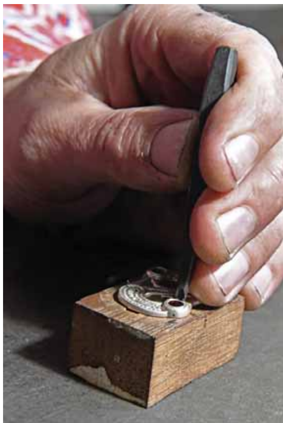
Obr. F-7: Temování krajů otvoru čakanem; foto: Eva Řezáčová © Technické muzeum v Brně
