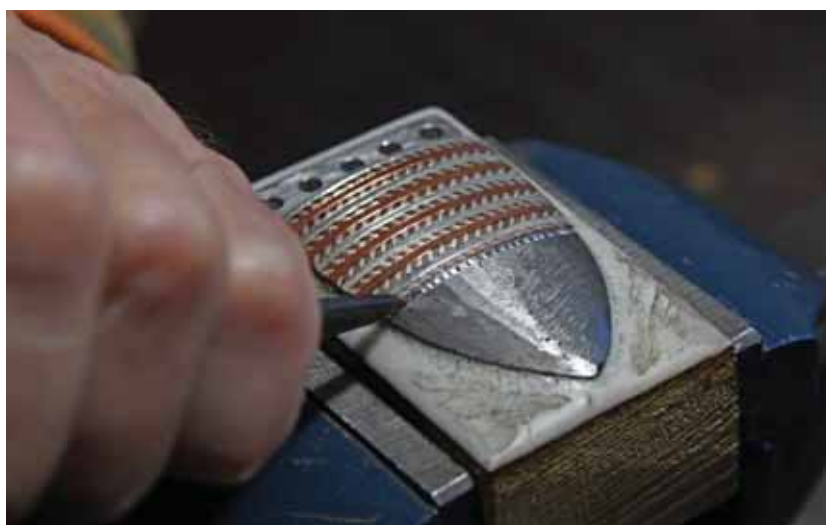
Obr. C-4: Příprava drážek a jejich zdrsnění záseky sekáčkem; foto: Eva Řezáčová ©Technické muzeum v Brně
