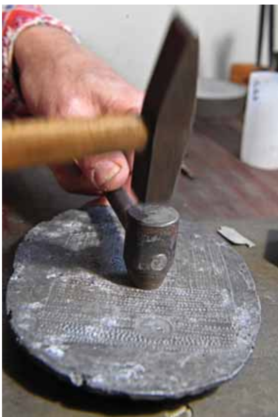
Obr. F-3: Ražení – štancování dekorativního vzoru fólie ocelovou raznicí na olověné desce; foto: Eva Řezáčová © Technické muzeum v Brně
