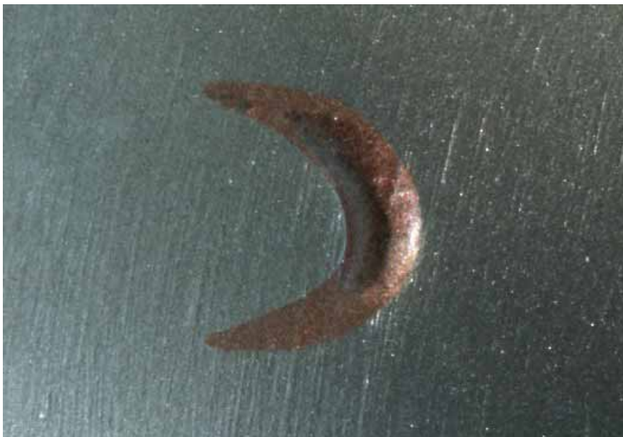
Obr. E-2: Neúplné zalití prohlubně inkrustačním kovem; foto: Patrick Bárta © Technické muzeum v Brně
