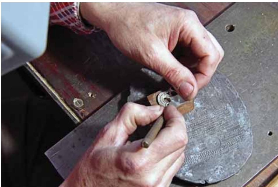
Obr. F-2: Příprava podkladní reflexní fólie – vyznačení potřebného tvaru a rozměru na stříbrný plech a posléze vystřížení fólie; foto: Eva Řezáčová © Technické muzeum v Brně
