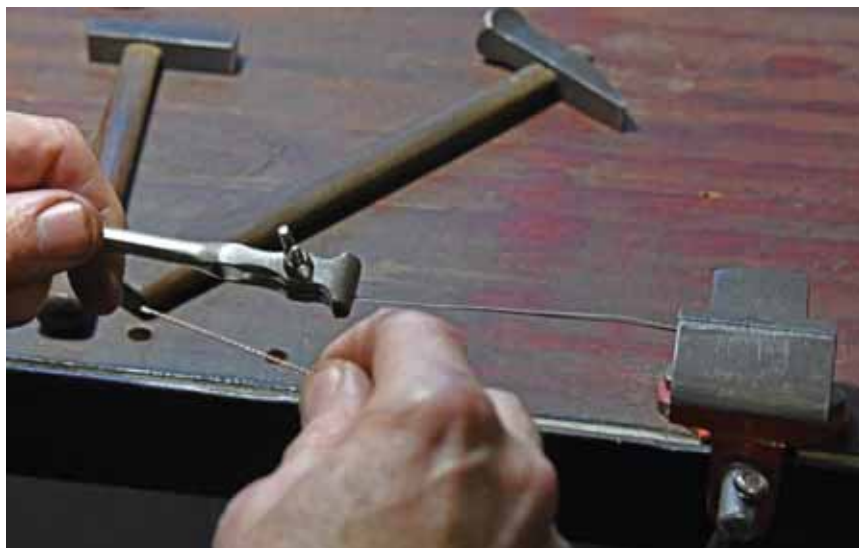
Obr. C-5: Příprava vložek – společné stáčení stříbrného a měděného drátku; foto: Eva Řezáčová© Technické muzeum v Brně
