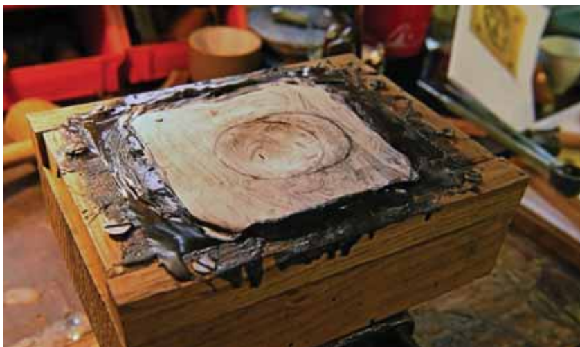
Obr. B-6: Prohloubený plech vlepený do tepařského tmelu před opětovným překreslením motivu; foto: Eva Řezáčová © Technické muzeum v Brně
