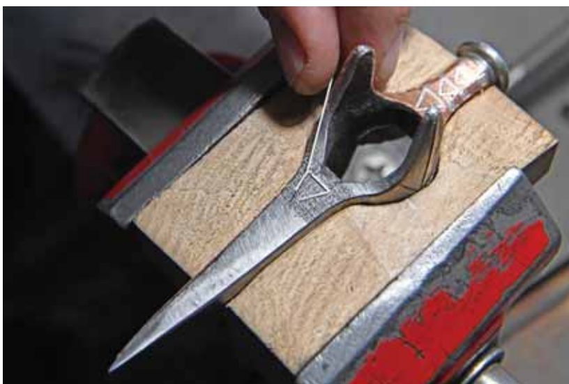
Obr. D-6: Aplikace stříbrného drátku na zdrsňený povrch; foto: Eva Řezáčová © Technické muzeum v Brně
