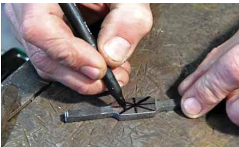
Obr. E-5: Předkreslení dekoru; foto: Eva Řezáčová © Technické muzeum v Brně
