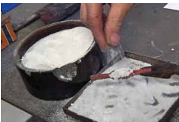
Obr. E-9: Posypání tavidlem – boraxem a mosaznými pilinami; foto: Eva Řezáčová © Technické muzeum v Brně
