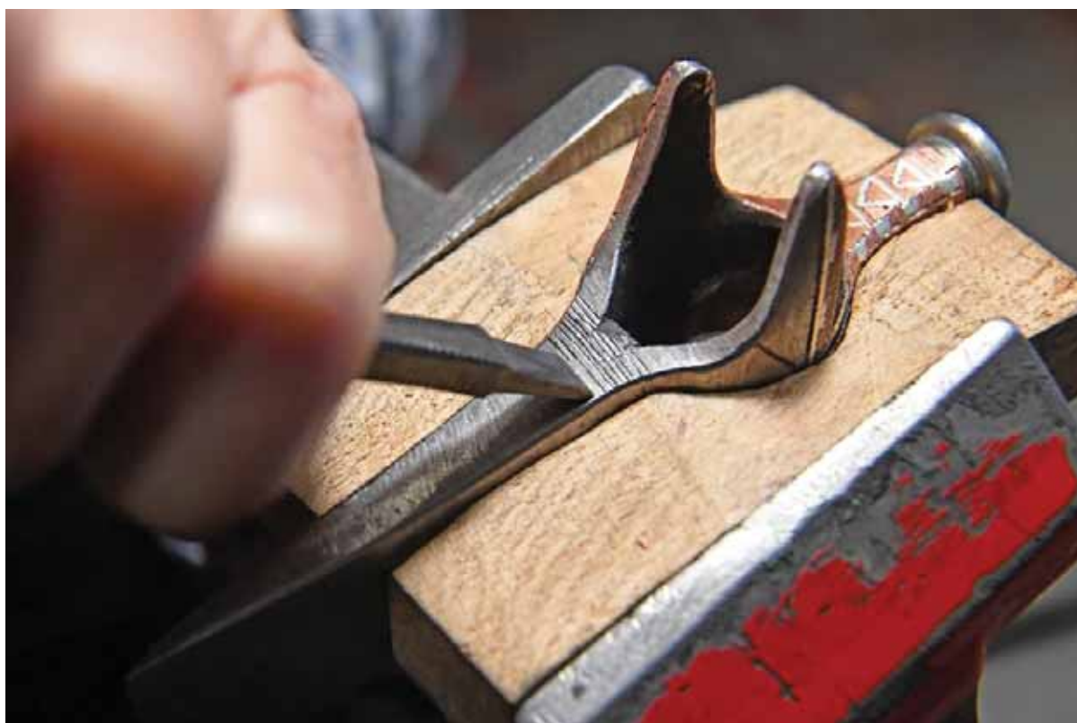
Obr. D-4: Zdrsňení povrchu rýhami za použití sekáčku; foto: Eva Řezáčová © Technické muzeum v Brně
