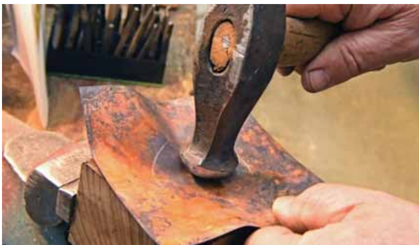
Obr.B-5: Vytvarování nejhlubšího místa na připraveném špalíku; foto: Eva Řezáčová © Technické muzeum v Brně
